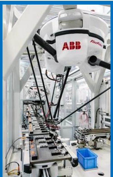
Ilustración 2. Sistemas de producción automática para la industria de elementos electrónicos.
