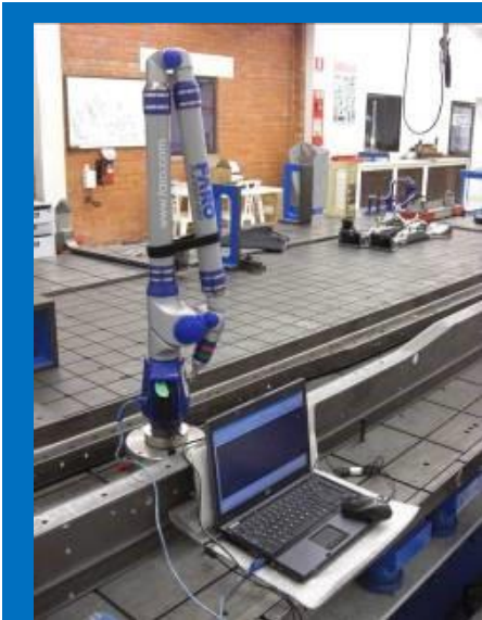
Ilustración 2. Laboratorio de metrología para el desarrollo de piezas y ajuste de procesos en FANALCA.
