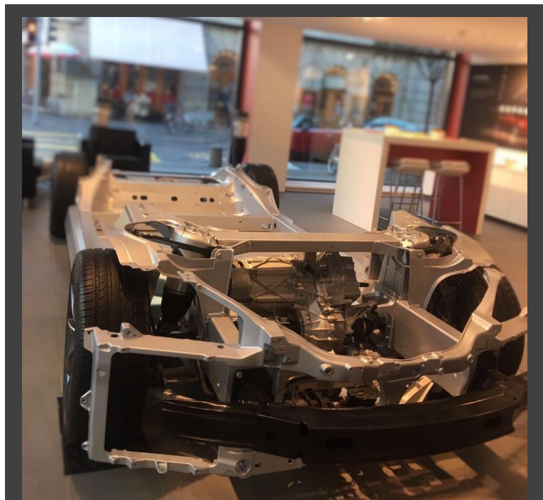
Ilustración 3. Chasis de un TESLA. Las diferencias en disposición, transmisión de potencia, motor, fuente de energía, hacen este vehículo eléctrico diferente.
